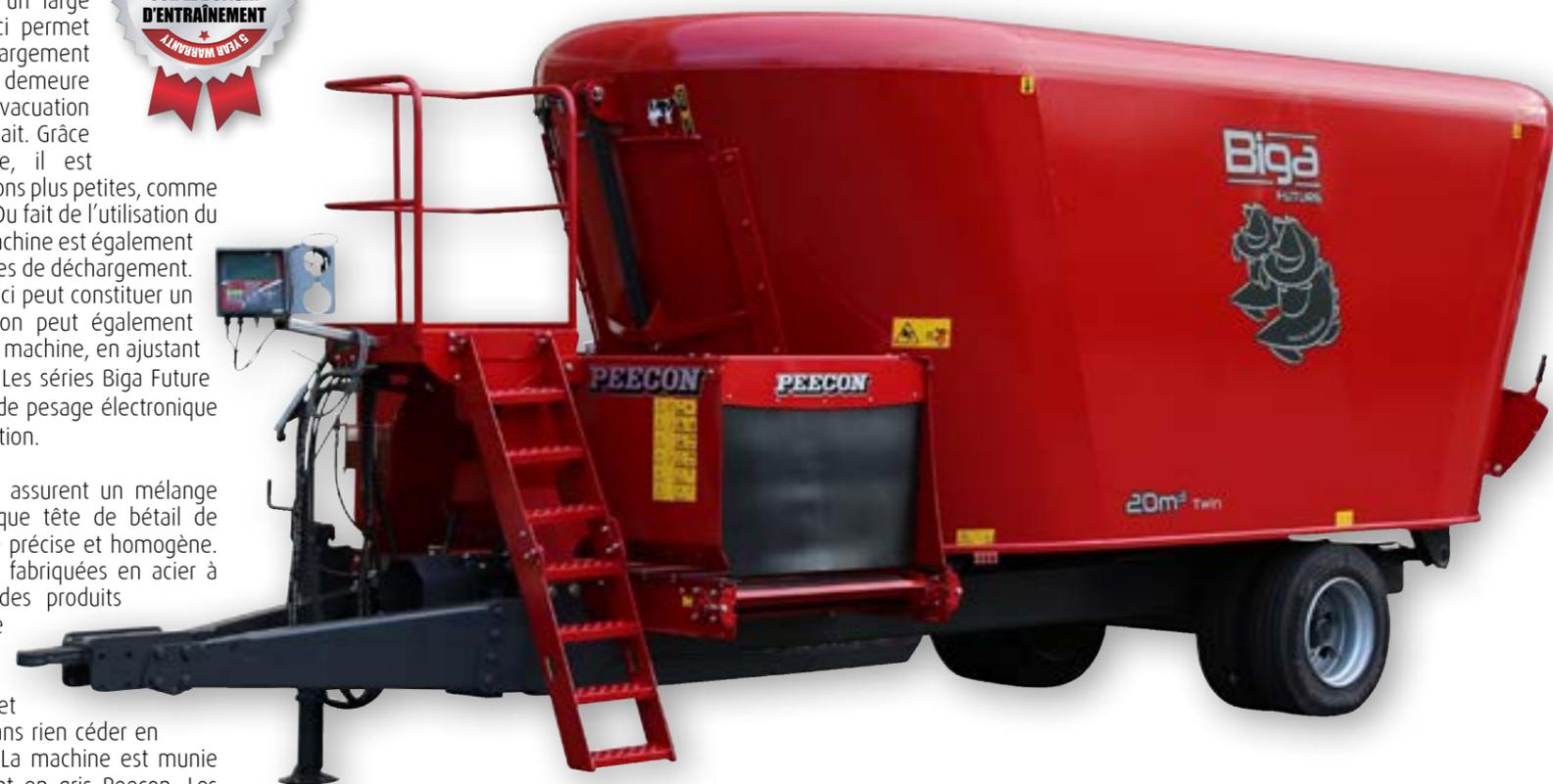
Les vis uniques Peecon à Double Action assurent un mélange rapide et homogène qui permet à chaque tête de bétail de recevoir une ration mélangée de manière précise et homogène. Les vis sont particulièrement épaisses et fabriquées en acier à haute résistance. Pour des rations et des produits spéciaux, Peecon dispose également de vis adaptées.
