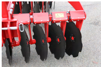
Suspension à barre de torsion des disques
