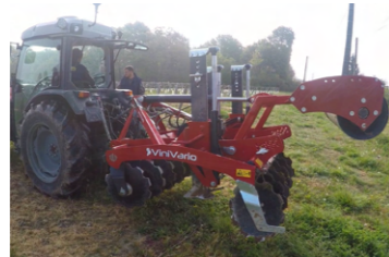
De Multidisc ViniVario-S is standaard voorzien van onderhoudsvrije lagering.
