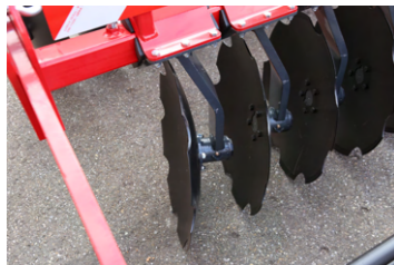
Suspension à barre de torsion des disques
