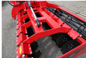
De Multidisc XLH is standaard voorzien van onderhoudsvrije lagering.
