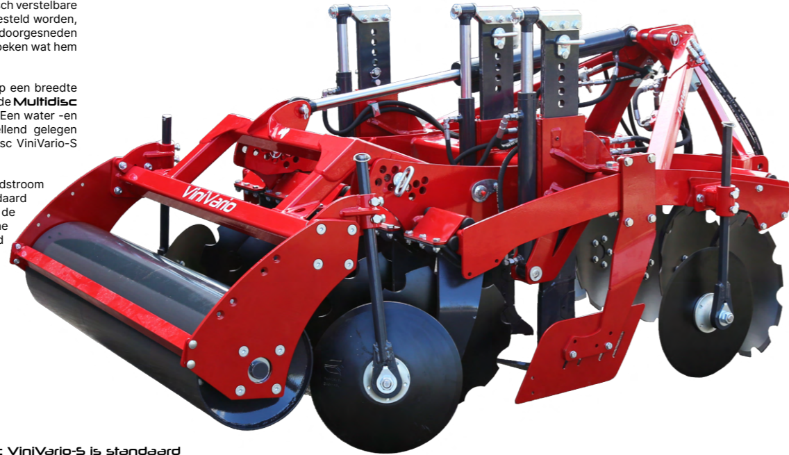
De Multidisc ViniVario-S is standaard voorzien van onderhoudsvrije lagering.
