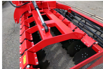
De Multidisc XXLH is standaard voorzien van onderhoudsvrije lagering.
