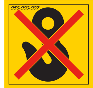
Fig. 3-20 ACHTUNG! Kein Hebepunkt. Befestigen Sie hier keine Seile, Ketten oder anderes Hebezeug. Dies führt zu Schäden an der Maschine.
