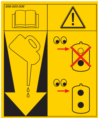
Fig. 3-17 ACHTUNG! Achten Sie darauf, dass der Ölstand des Untersetzungsgetriebes im obersten Schauglas sichtbar ist (nur für Modelle mit Ölbehälter aus Stahl).
