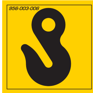
Fig. 3-16 ACHTUNG! So sind Hebepunkte gekennzeichnet. Heben Sie die Maschine ausschließlich an diesen Punkten an.
