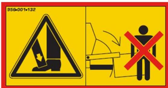
Halten Sie Abstand von der sich bewegenden Ladeklappe. Körperteile können eingeklemmt werden.
