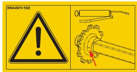
Ist Ihr Schneidemischwagen mit Achsen ausgestattet, kann an der Nabe der Achse ein Schmierpunkt vorhanden sein.
