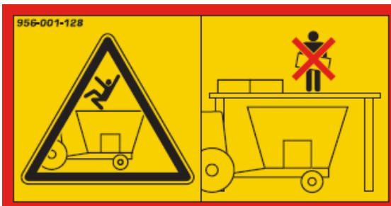
Das Besteigen oder Betreten des Podests ist verboten. Lassen Sie keine Personen die Maschine von Hand über das Podest beladen (Einsturzgefahr).
