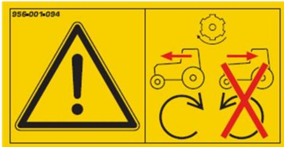
Vorwärtsfahren mit laufender Zapfwelle ist erlaubt. Rückwärtsfahren ist nur mit stillstehender Zapfwelle zulässig, außer es wird eine Umkehrzapfwelle verwendet (achten Sie auf die Drehrichtung).
