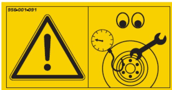
Ziehen Sie die Radmuttern nach der ersten Betriebsstunde und danach alle 25 Stunden mit 310 Nm nach und überprüfen Sie den Reifendruck.
