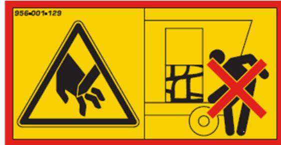
Quetsch- und Schneidefahrer an der Mischkammer. Halten Sie Abstand von der Dosieröffnung. Entfernen Sie bei Arbeiten immer den Zündschlüssel und kuppeln Sie die Zapfwelle ab.
