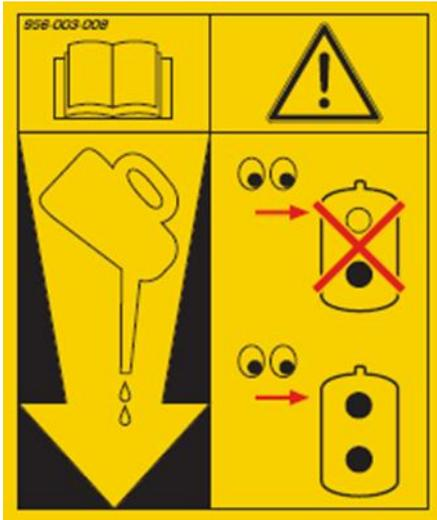
Stellen Sie sicher, dass der Ölstand des Planetengetriebes im oberen Schauglas sichtbar ist (nur bei Modellen mit Stahl-Ölbehälter).
