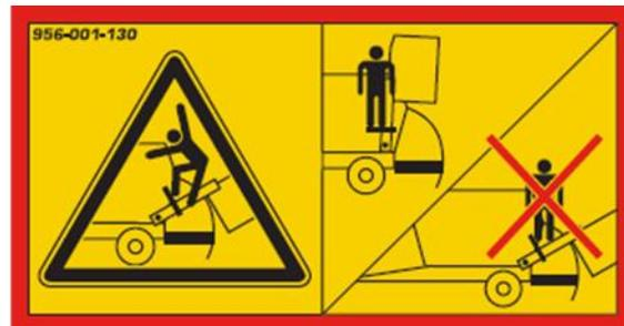
Benutzen Sie den Aufstieg nur, wenn die Ladeklappe vollständig geschlossen ist und der Futtermischwagen stillsteht.
