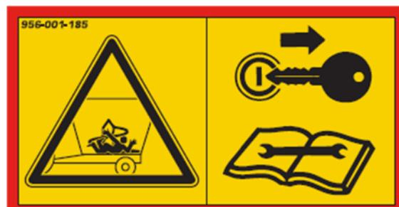
Halten Sie Abstand von rotierenden Teilen. Schalten Sie die Maschine bei Wartungsarbeiten immer aus und entfernen Sie den Zündschlüssel.
