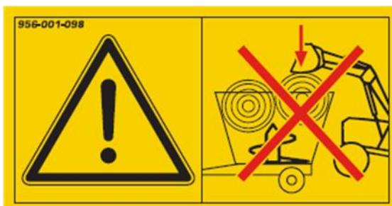
Es wird davon abgeraten, das Ladegut in der Mischkammer anzupressen. Dies kann Schäden oder Störungen am Traktor oder an der Maschine verursachen.
