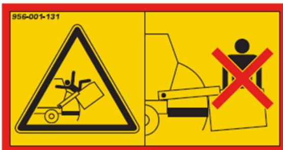
Steigen Sie niemals in die Ladeklappe des Schneidemischwagens. Sturz oder Quetschung können zu schweren Verletzungen führen.
