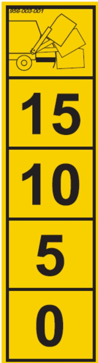
Die Stellung der Ladeklappe ist vom Traktor aus an der Deichsel über die Anzeige-Stange und den entsprechenden Aufkleber ablesbar. Stellung „0“ bedeutet, dass die Klappe vollständig unten ist. Der abgelesene Wert, multipliziert mit 6, ergibt den Öffnungswinkel in Grad. Stellung „15“ bedeutet, dass die Klappe in einem Winkel von 90° steht und somit geschlossen ist.
